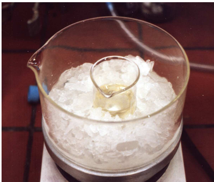
Abbildung 5: Zugeben von Zinnchlorid-Pentahydrat zur Natriumsulfid-Lösung. Man erkennt die Gelbfärbung.
